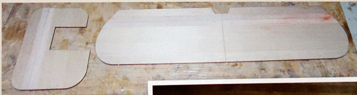
Die Randbögen werden über eine mitgelieferte Schablone angezeichnet und rund geschliffen, nicht geschnitten!
