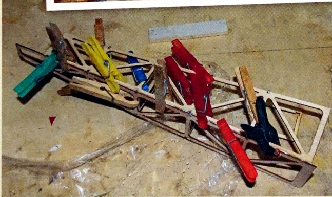
Das Rumpferüst wird zusammengefügt
